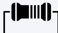
Regular la corriente: Evita que componentes sensibles (como LEDs o transistores) reciban corriente excesiva que pueda dañarlos.
